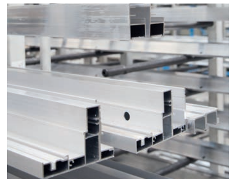
Jeder Profilkontur gewachsen: Die Auflagetische der Anlagen sind mit zwei NC-gesteuerten und unabhängig voneinander verfahrbaren Rollengängen ausgestattet. Die automatische Profilvermessung verhindert, dass fälschlicherweise aufgelegte Profile bearbeitet werden.
