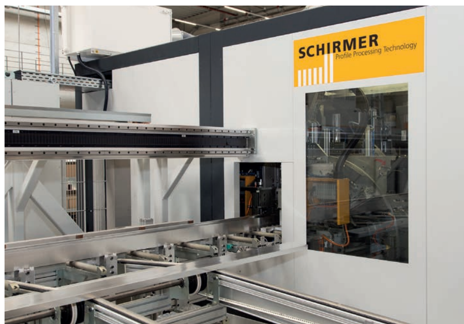
Jeder Profilkontur gewachsen: Die Auflagetische der Anlagen sind mit zwei NC-gesteuerten und unabhängig voneinander verfahrbaren Rollengängen ausgestattet. Die automatische Profilvermessung verhindert, dass fälschlicherweise aufgelegte Profile bearbeitet werden.
