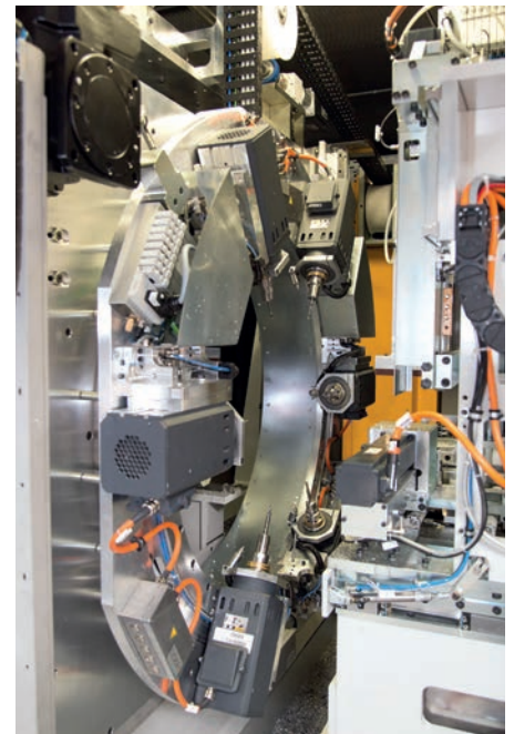
Das Alu-BAZ Composite ist mit seinen sechs Fräsmotoren auf dem um 360 Grad drehbaren Ring auf hohe Leistung ausgelegt.
