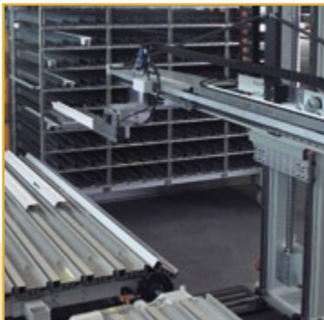
Robot de apilado PSR con 15 sec. por ciclo Apilado de perfiles en carros controlado por 3 ejes NC
