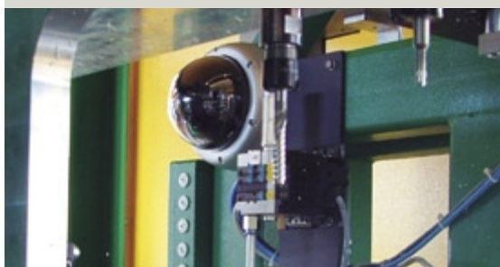
Control de estado de herramientas - Control por láser y cámaras
