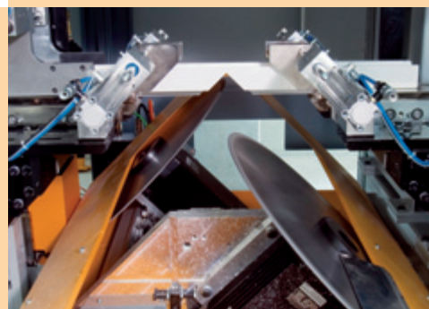
Debitare VU - ULTRA SPEED 45°/135° Debitarea intr-un ciclu de aprox. 7 secunde/profil
