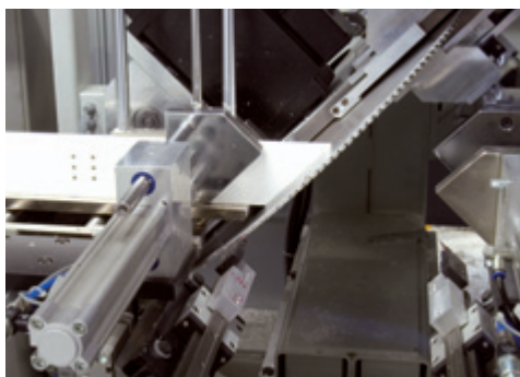
Debitare la unghi FLEX 45°–135° reglare la unghi 30°–150° optional
