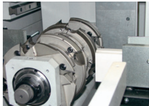
Modul de frezare pentru montant si stulp
