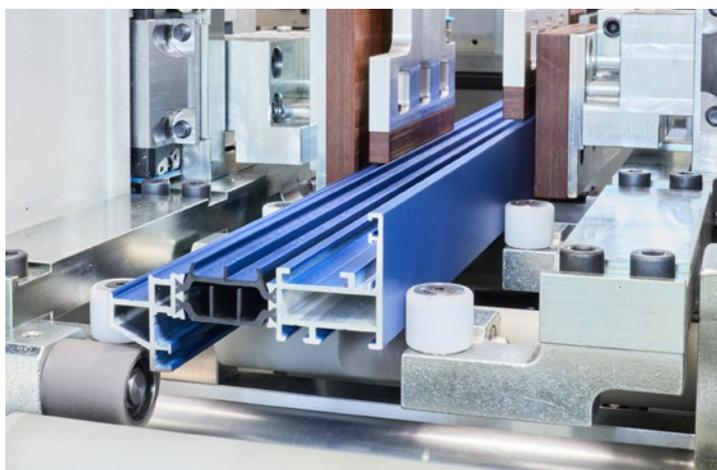
Éléments de guidage et bridages adaptés à un profilé d'ouvrant complexe
