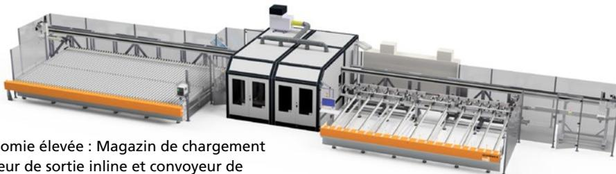
Alu-BAZ avec haute productivité : 2 modules d'usinage séparés incluant module de débit
