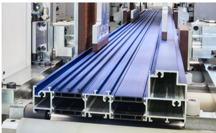
Éléments de guidage et bridages adaptés à un profilé large et bas
