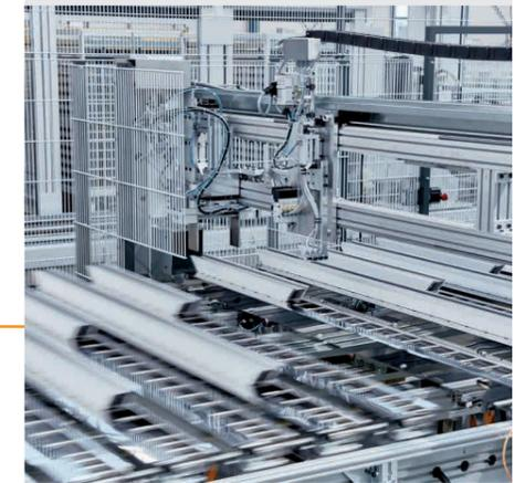
**Schraubmodul mittels Servomotoren**
